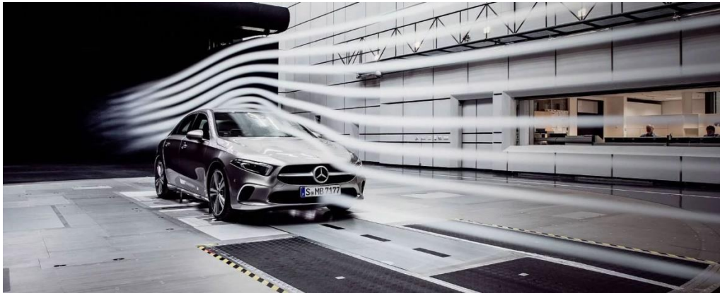
Ilustración 11: Prueba aerodinámica en túnel de viento
